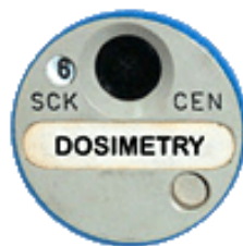
Figuur 2.6: Persoonsdosimeter van SCK•CEN. [27]
