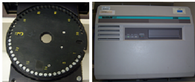
Figuur 2.8: Foto uitleestoestel Automatic TLD Reader 4000 gehanteerd door SCK•CEN.
