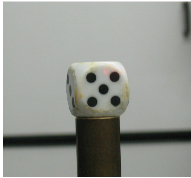
Figuur 4.5: Een dobbelsteen, vastgelijmd op een stabiele metalen houder op een magneetvoet.
