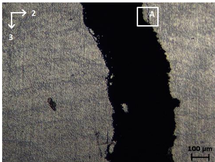
Figuur 55: Zijvlak na translaminaire breuk
