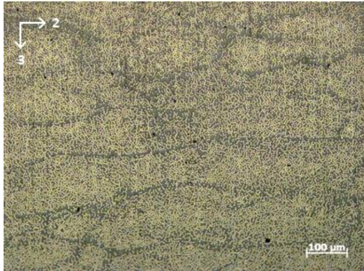
Figuur 54: Zijvlak koolstofvezel-epoxy composiet na polijsten
