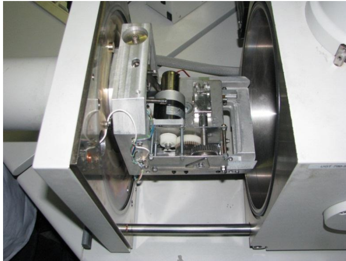
Figuur 44: Toestel voor buigproef in de SEM
