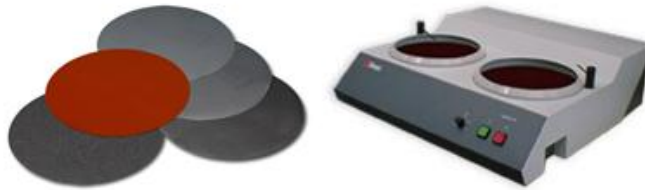
Figuur 27: Polijstdoeken en polijstmachine [43]
