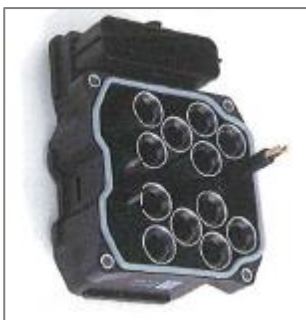
Figuur 4: ECU-module voorzien van 12 spoelen (TE Connectivity, 2012)
