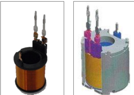
Figuur 36: EBC-460 spoel zonder en met fluxring om de elektromagnetische stromen te bundelen en dus de inductie te versterken
