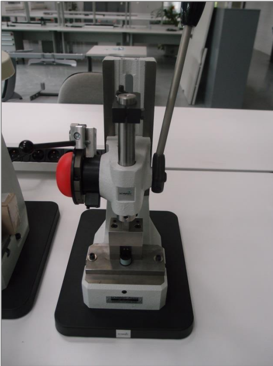
Figuur 81: Pers/Knacker met daarop de indruktool en een spoel
