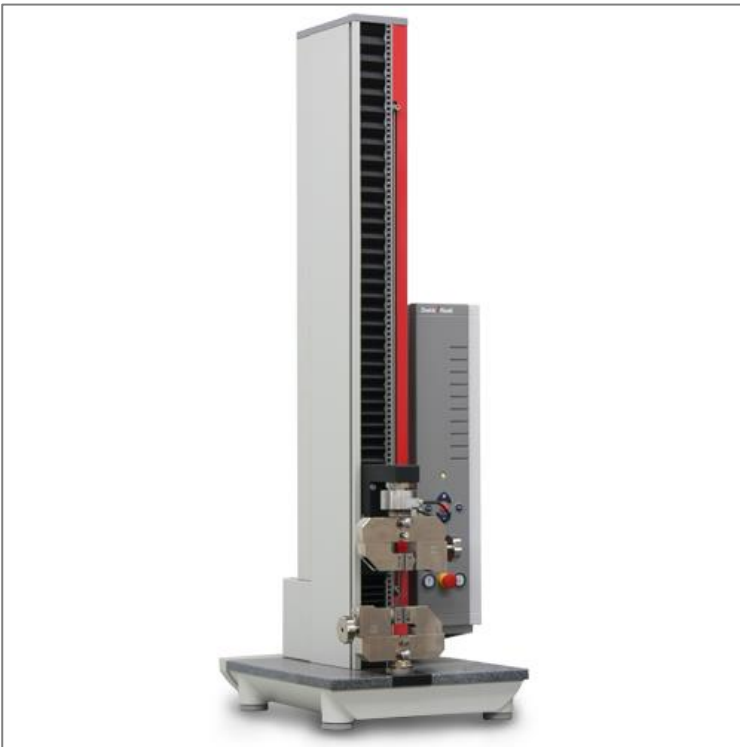
Figuur 114: Trekbank waarop de treksterktetest wordt uitgevoerd (TE Connectivity, 2012)
