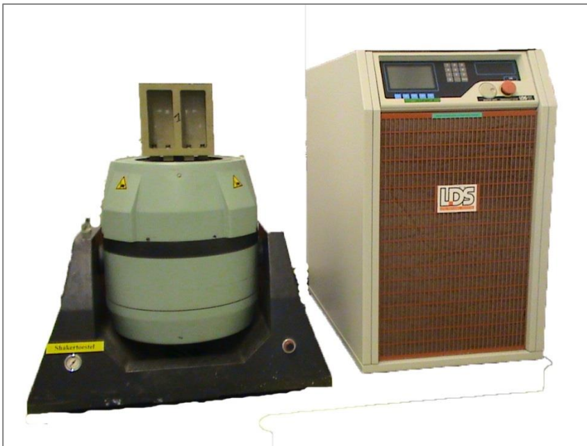
Figuur 110: Shakertoestel met daarop een vibratieklemblok gemonteerd (TE Connectivity, 2012)
