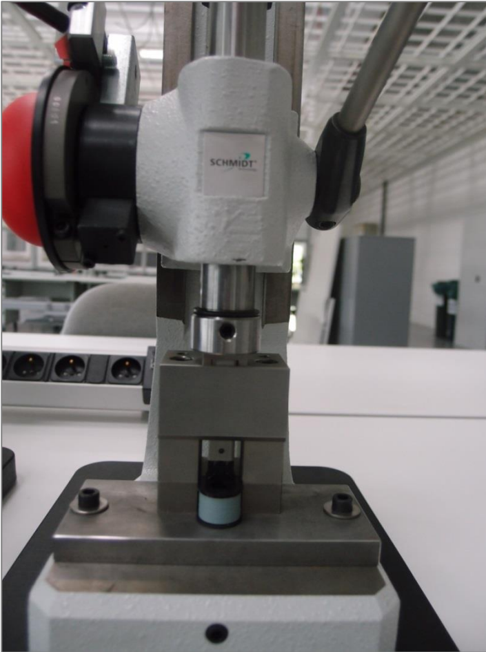
Figuur 77: Indruktool met spoel bevestigd op een manuele pers met tweehandsbediening
