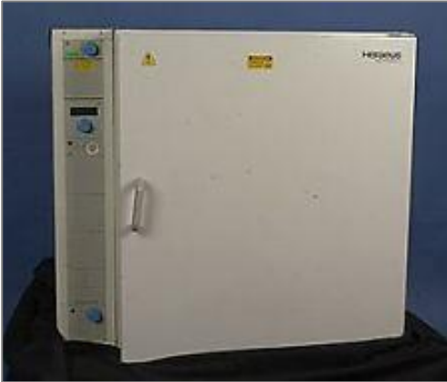
Figuur 108: Oven voor de temperature durability test (TE Connectivity, 2012)
