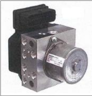
Figuur 5: HCU-module met achteraan ECU (TE Connectivity, 2012)
