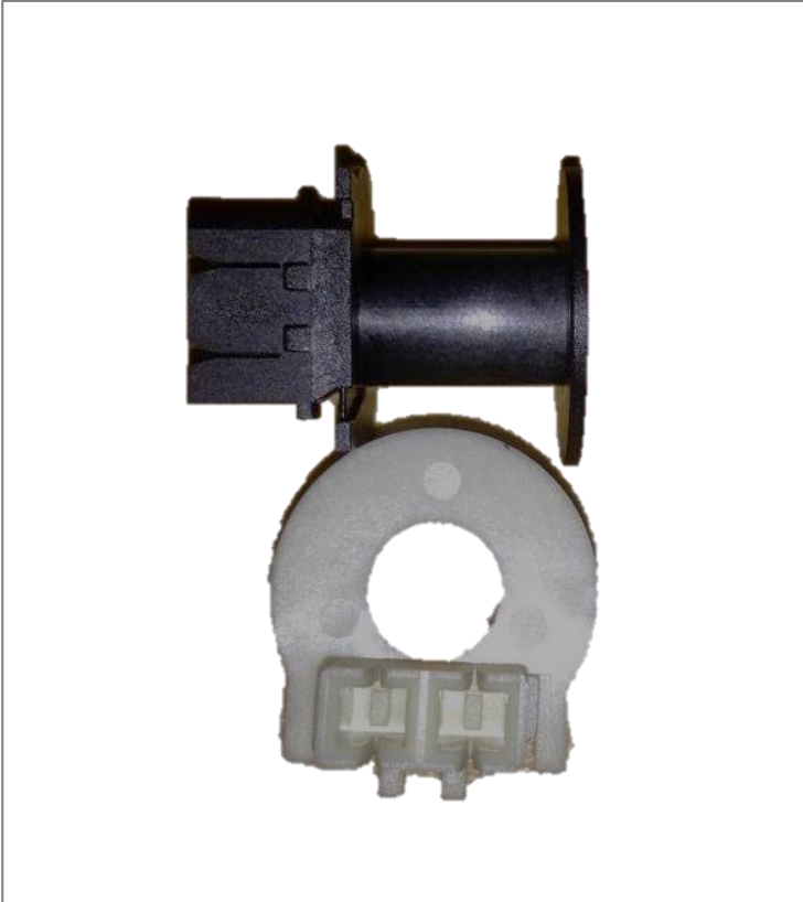
Figuur 73: Geproduceerde bobijnen net na de eerste spuitgietingen
