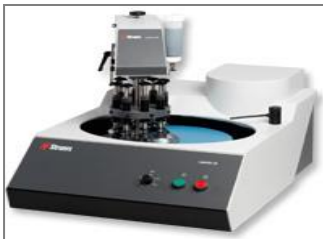
Figuur 92: Vlaktafel om schliffs te vlakken (TE Connectivity, 2012)
