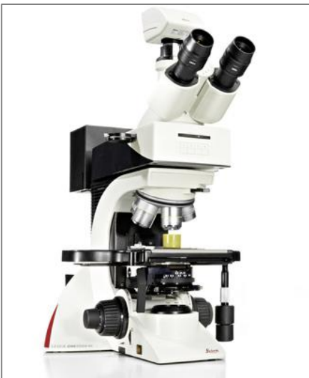
Figuur 93: Lichtmicroscop om schliffs te bekijken (TE Connectivity, 2012)
