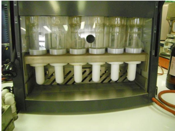
Figuur 13: Extractieapparaat voor vet, met extractiehulzen
