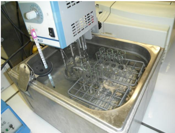
Figuur 12: Warmwaterbad waarin proefbuizen met fermentatiemedium en enzym zit
