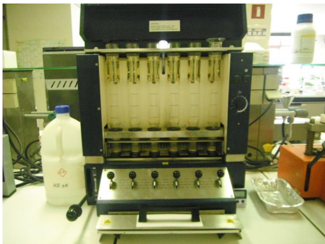
Figuur 14: Het Fibertec apparaat voor ruwe celstofanalyse, met kroesjes
