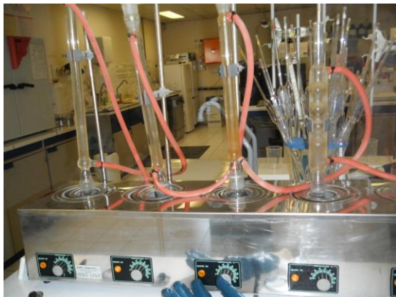
Figuur 16: Kokend waterbad met terugvloeiakoeler
