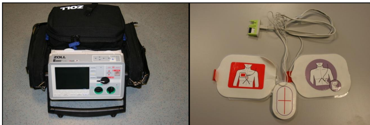
Figuur 1: Links: De Zoll E-Series defibrillator. Rechts: CPR D-Padz, bestaande uit twee defibrillator pads, een accelerometer en een verbinding naar de defibrillator
