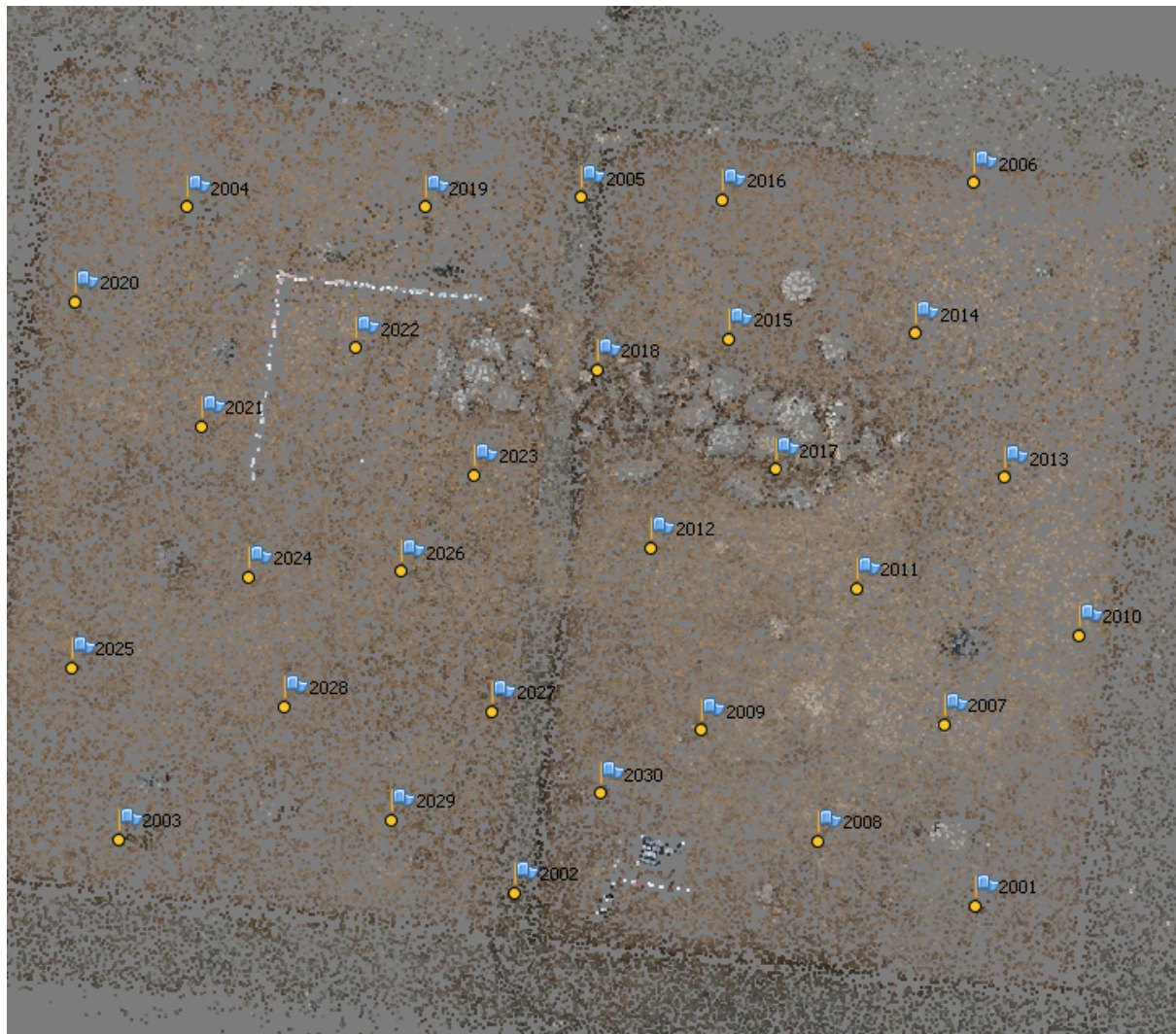
Figuur 25: Resultaat van de alignment : een driedimensionale puntenwolk
