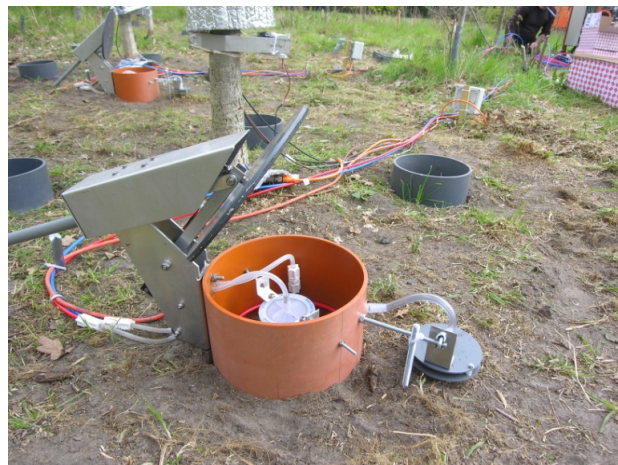
Figuur 3.3: Op de voorgrond een automatische bodemkamer (oranje ring) gebruikt voor bepaling van bodem \text{CO}_2 efflux.
