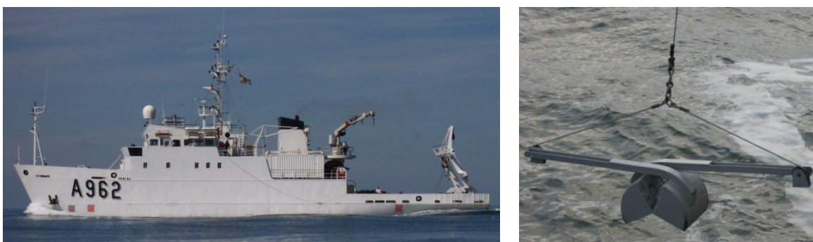
Figuur 2.3: Belgica RV, onderzoeksschip van de Belgische regering (links) en de Van Veen grijper die zich op het schip bevindt en gebruikt werd voor de sedimentstalen (rechts)
