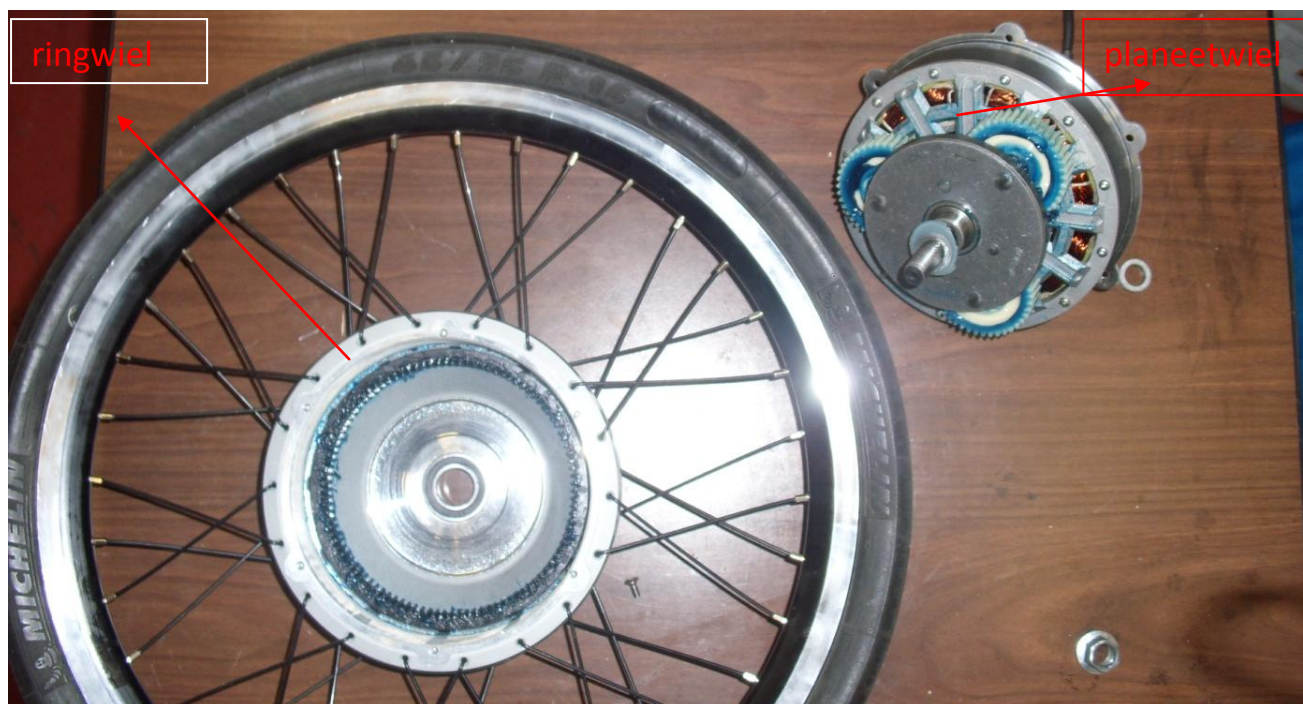
Figuur 38: planetair tandwielstesel in Bafang motor
