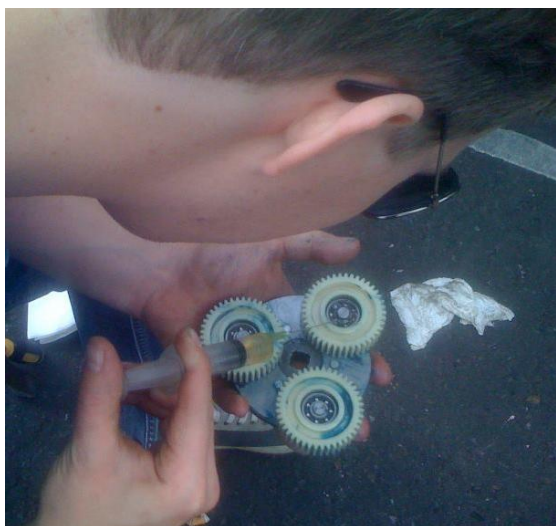
Figuur 75: lagers vrijloopsysteem smeren
