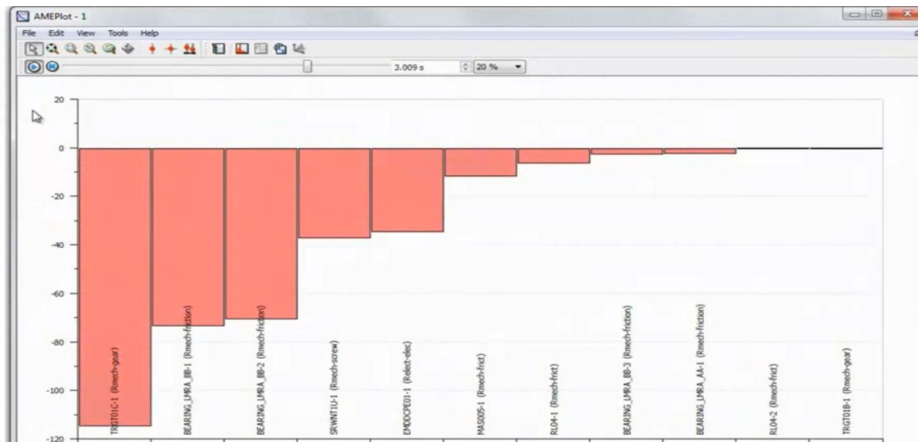
Figuur 18: Resultaat van de analyse: grootste verlies bij de overbrenging (LMS International, 2012)
