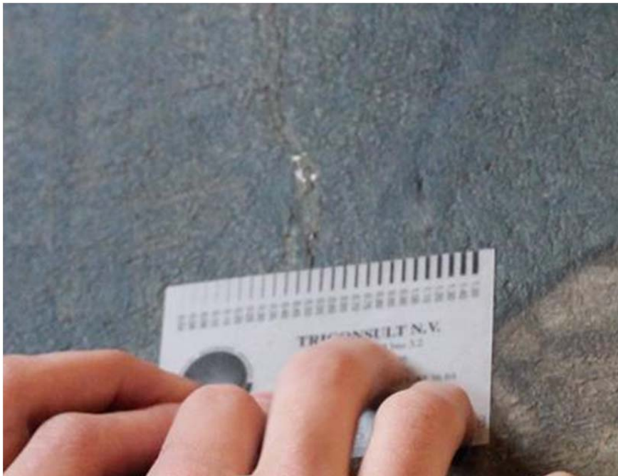
Figuur 55: opmeting scheurbreedte met Triconsul –kaartje
