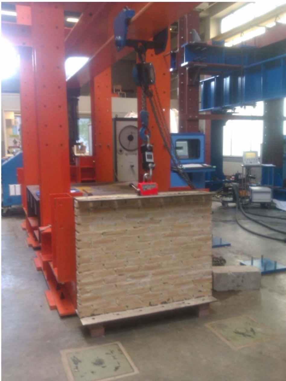
Figuur 35: opstelling trekproef loodrecht op de langse voegen
