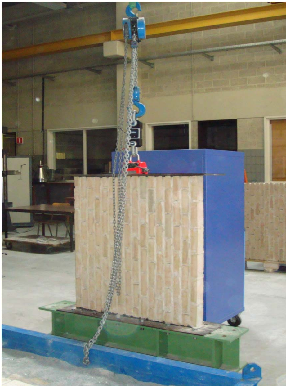
Figuur 37: opstelling trekproef evenwijdig met de langse voegen
