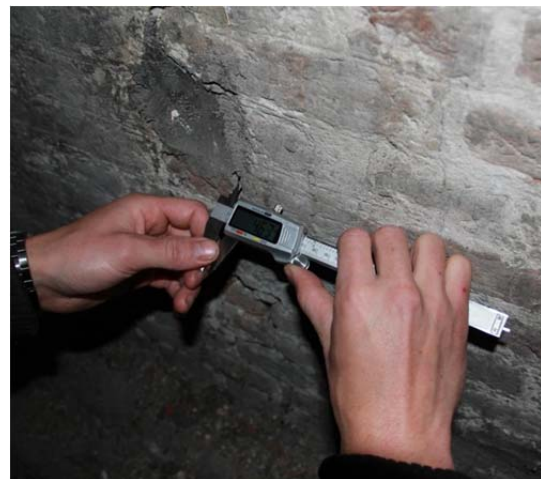
Figuur 59: opmeten scheurbreedte zolder m.b.v. digitale schuifmaat
