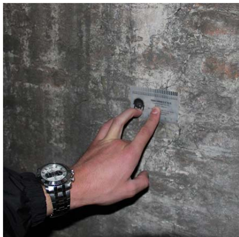
Figuur 58: opmeten scheurbreedte zolder m.b.v. scheurkaartje
