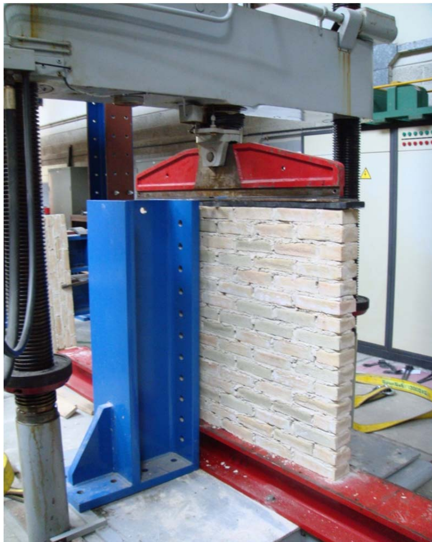
Figuur 31: opstelling drukproef loodrecht op langse voegen
