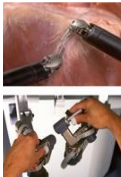
Fig. 6: Translatie van de handbewegingen van de chirurg naar de instrumenten (9)
