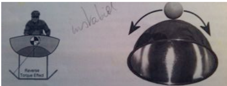
Figuur 35: Een stabiel systeem waarbij het rolpunt zich boven het CG bevindt [13]
