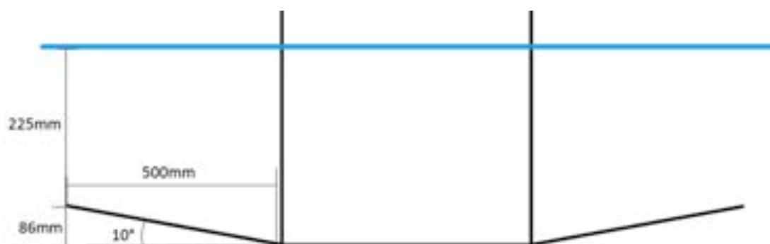
Figuur 44: Ventilatie minimale diepte
