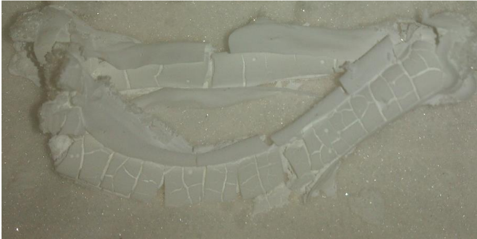
Figuur 6-15 – Geprint blokje na het sinteren, waarbij de buitenmantel langs de zijkanten niet gescheurd is.
