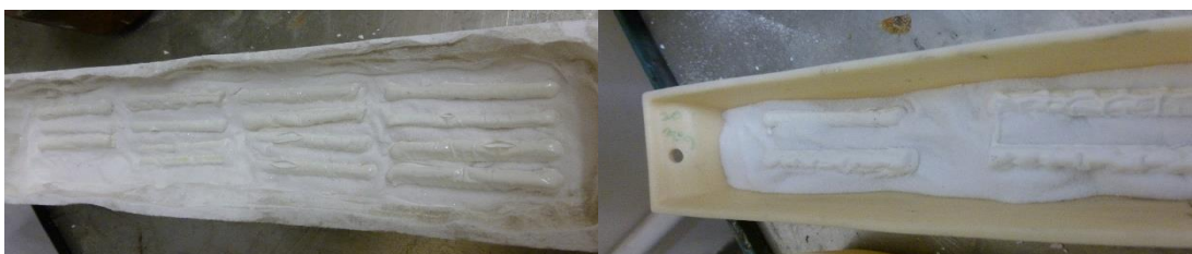
Figuur 6-4 – Houders met Alumina-poeder voor de stukken tijdens debinding en sinteren
