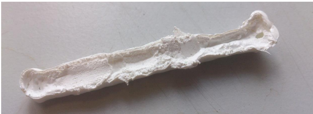
Figuur 6-12 – Blokje dat zonder substraat thermisch gecured is.
