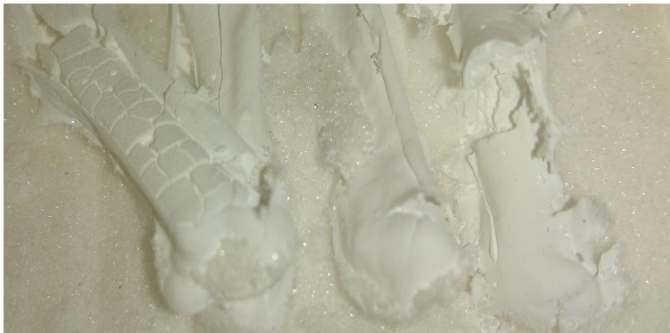
Figuur 6-14 – Geprinte blokjes na sinteren. In deze samples scheurde de buitenmantel, waardoor de blokjes vrij konden krimpen
