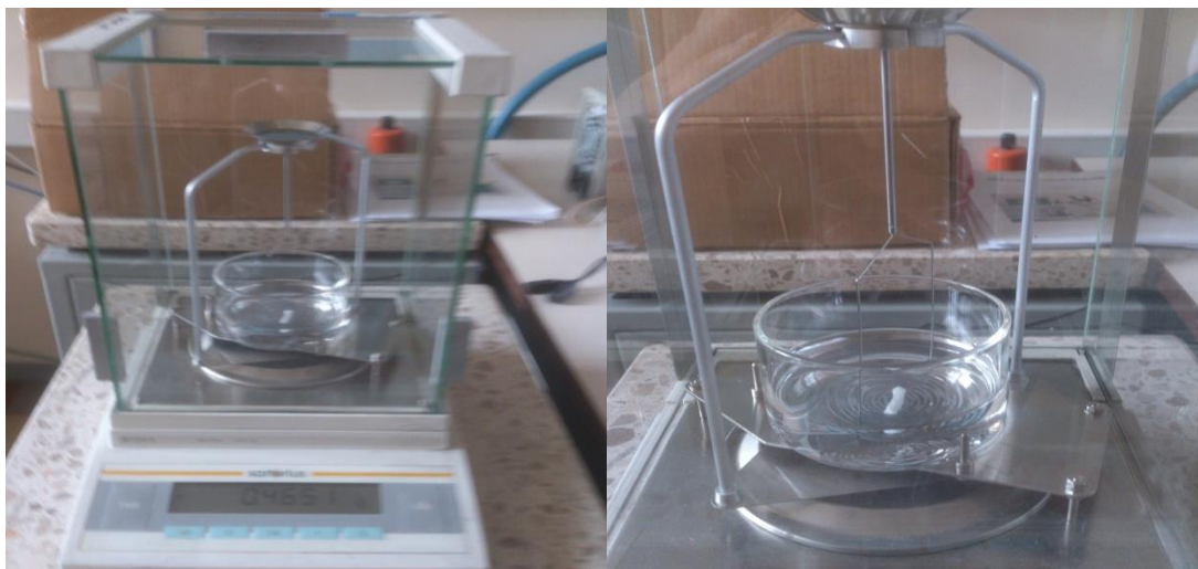
Figuur 6-6 - Opstelling om de densiteit met behulp van het Archimedesprincipe op te meten
