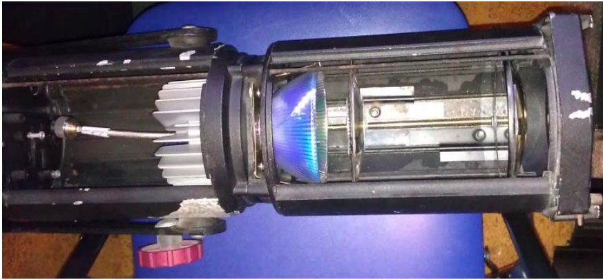
Figuur 40: Profielspot uitgerust met LEP
