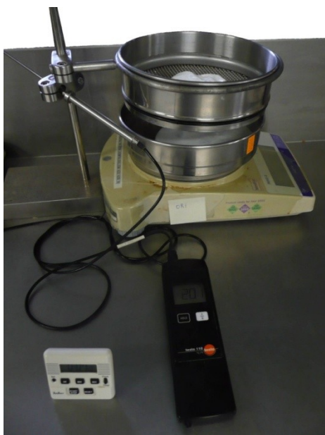
Figuur 5.6: Opstelling voor het opnemen van een smeltkarakteristiek. De zeef werd evenwijdig opgesteld met het oppervlak van de tafel. De thermometer werd gebruikt om de omgevingstemperatuur op te volgen. De meetsonde van de thermometer werd opgesteld ter hoogte van het afsmeltend ijs.
