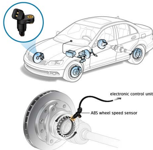
Figuur 2-10: ABS met actieve wielsnelheidssensoren 4
