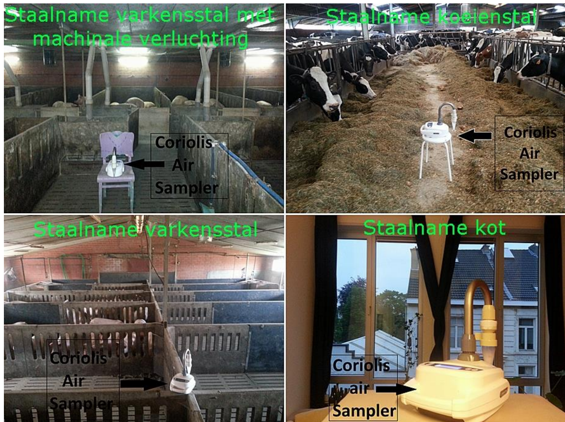
Figuur 3-1: Actieve staalname van de verschillende binnenhuis locaties m.b.v. de 'Coriolis Air Sampler'.
