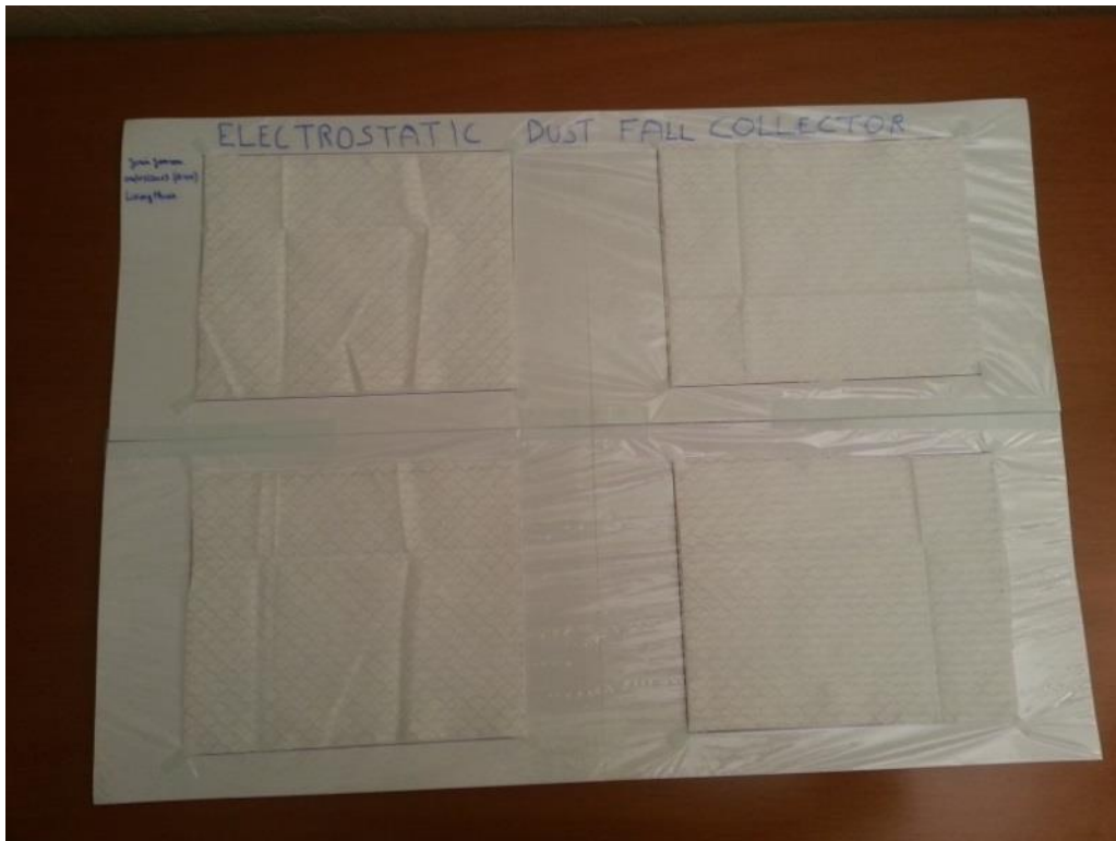
Figuur 2-3: zelf ontworpen EDC met vier elektrostatistische stofdoekjes, tijdens passieve staalname in de living.
