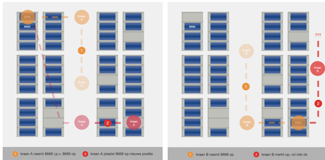
Figuur 2.1: Rolverwisseling door kraan
