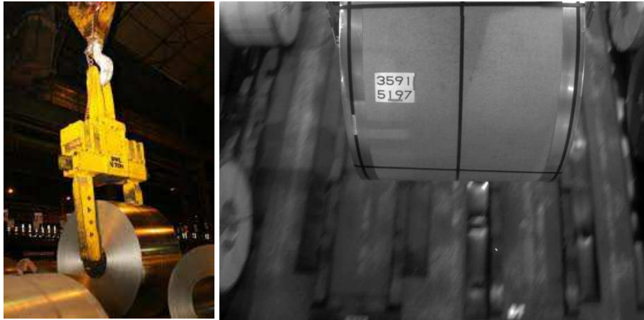
Figuur 1.2: Kraan verplaatst rol staal (links) en bovenaanzicht met rolnummer (rechts).
