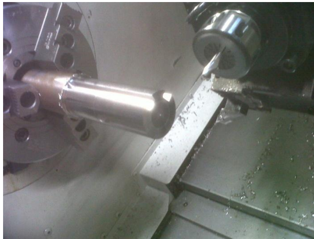
Figuur 33: Foto validatie-experimenten kopfrezen in axiale richting
