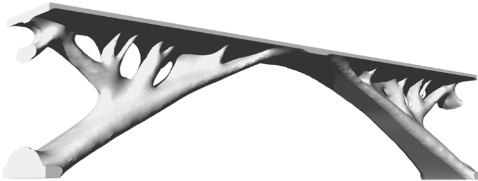
Figuur 4.22: Topologie-geoptimaliseerde boogbrug met hooggelegen rijvloer (incl. geometrische beperking). 3D-model rechtstreeks uit Abaqus.
