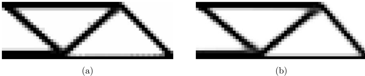
Figuur 3.2: Geoptimaliseerde resultaten geproduceerd met behulp van (a) Abaqus en (b) Matlab.
