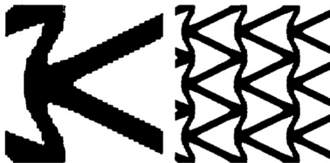
Figuur 4.44: Materiaal met een negatieve poisson-ratio [12].
