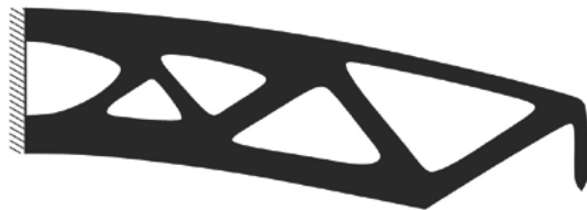
Figuur 2.16: Optimale resultaat van figuur 2.15b in de vervormde toestand. Gebaseerd op [25].
