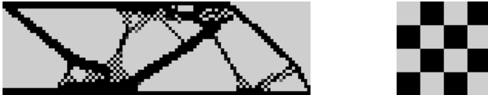
Figuur 2.4: Dambord-patroon vorming wanneer geen filter wordt gebruikt
