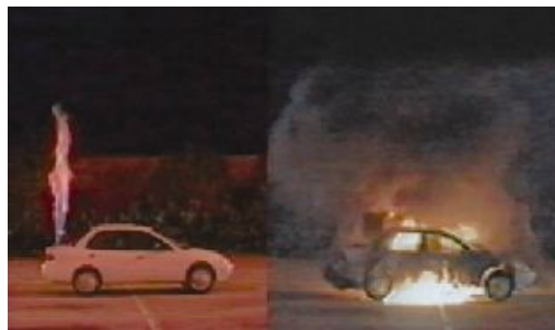
Figuur 7.5: Ontsteking brandstoftank, links waterstofauto, rechts LPG
