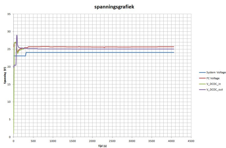
Figuur 11.19: Verloop van de elektrische spanningen in de opstelling
