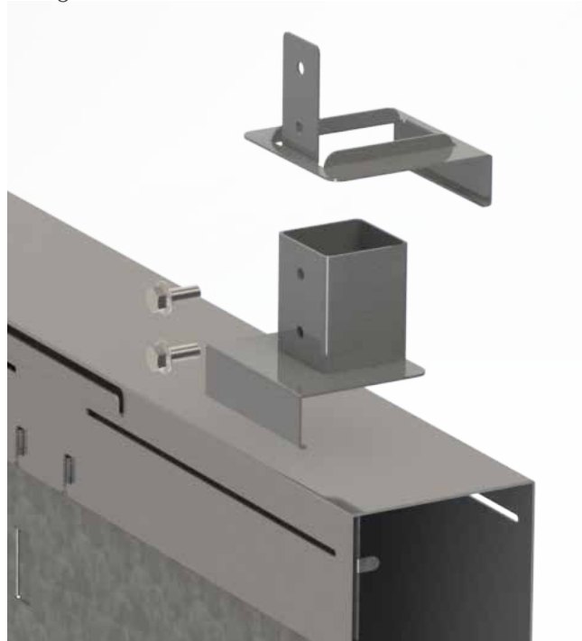
Afb.94: Bevestiging van de balustrade op de overkappingsplaten
