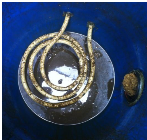
Figuur 17: Afzetting biomassa
