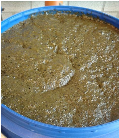
Figuur 13: Schuimvorming in vergister
