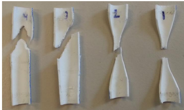
Figuur 20. Testmonsters na finale uni-axiale test.
