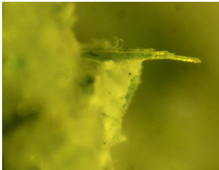
Figuur 52: Breukoppervlak van de trekstaaf
