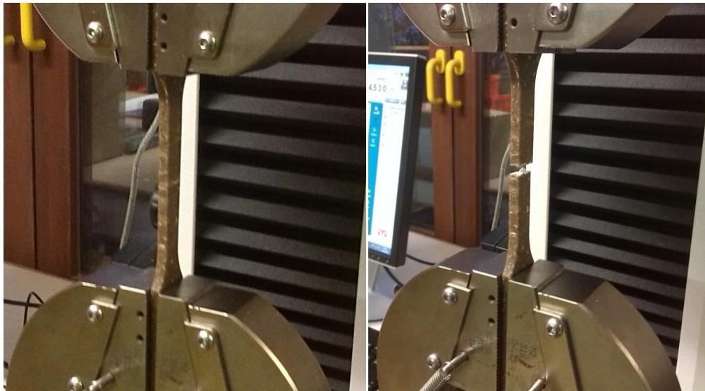
Figuur 42: Opstelling van de trekproef
