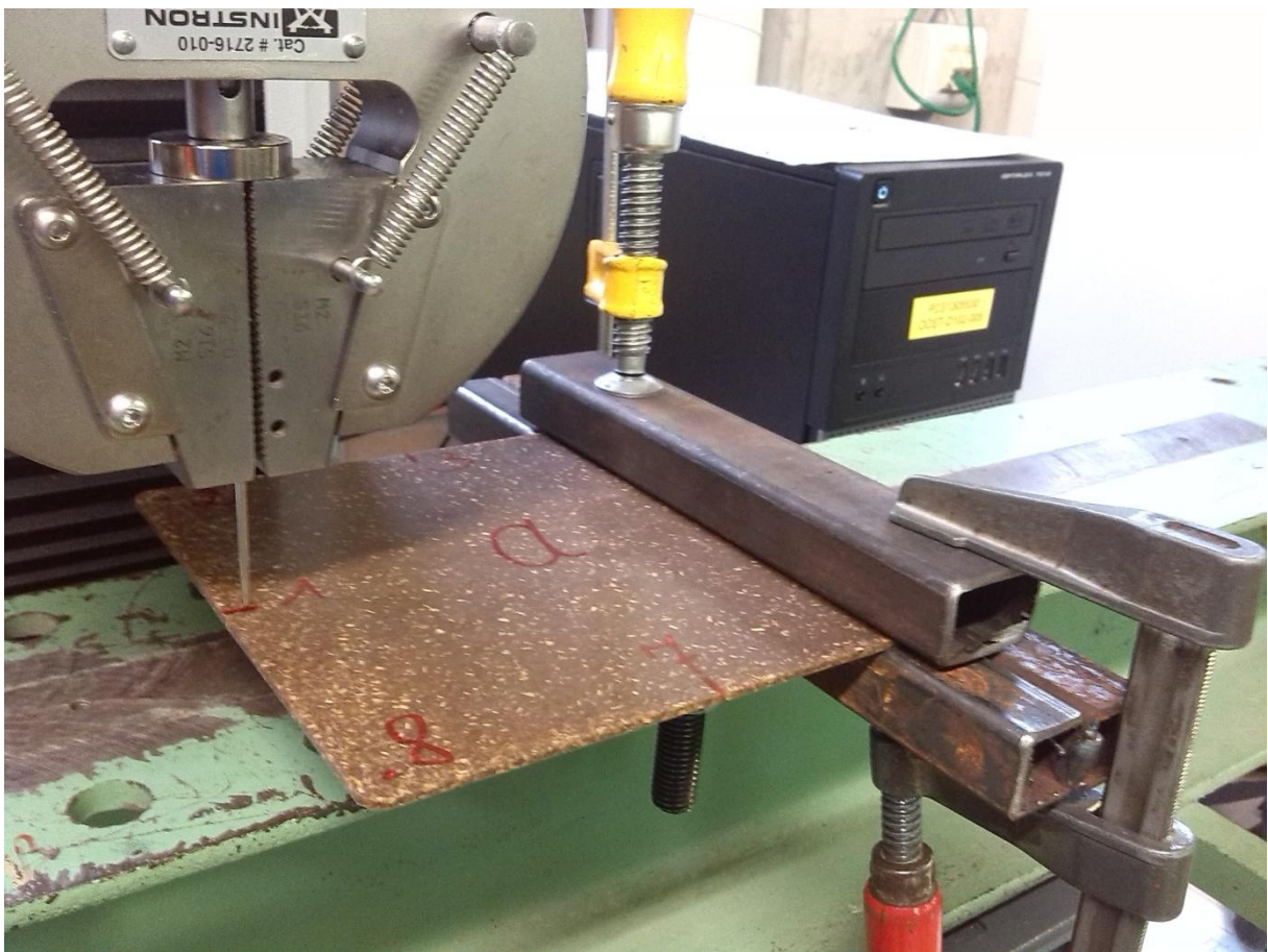
Figuur 59: Opstelling van de buigproef
