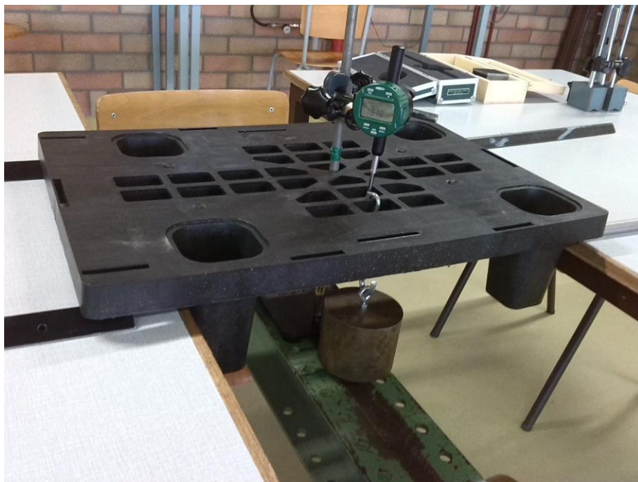
Figuur 106: Opstelling belastingsproef pallet
