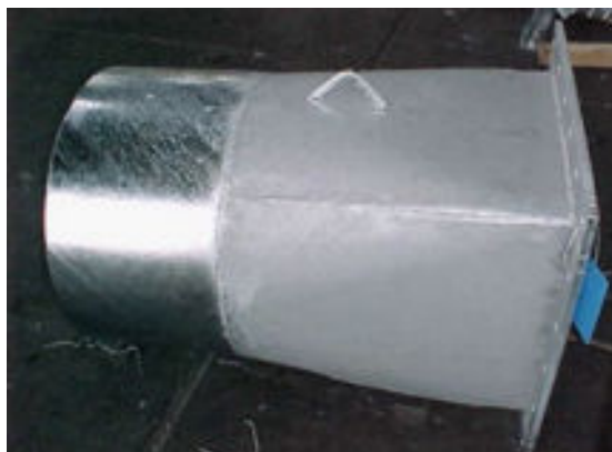
Figuur 2.2-10 Visueel verschil door verschil in staalsamenstelling [22]
