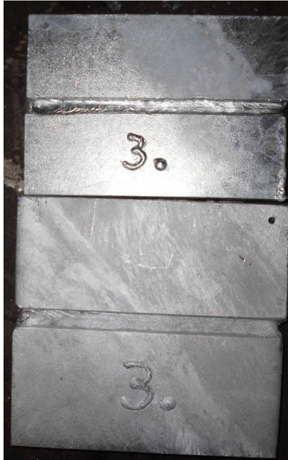
Figuur 4.5-1 Voorbeeld proefstukken V- en X-naad
