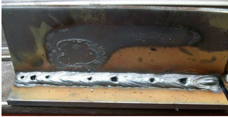
Figuur 4.8-1 Proefstuk gelast met lasdraad 1,0 mm en beschermgas Arcal 21
