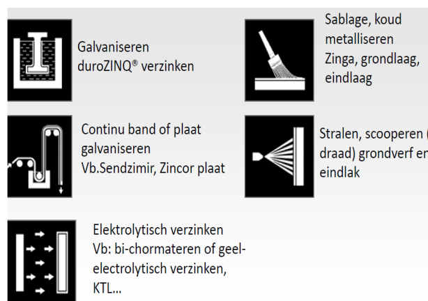
Figuur 2.1-2 Corrosiebeschermingsmethoden van staal door zink [5]
