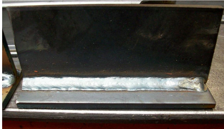
Figuur 4.8-3 Proefstuk gelast met lasdraad 1,0 mm en beschermgas Arcal 12
