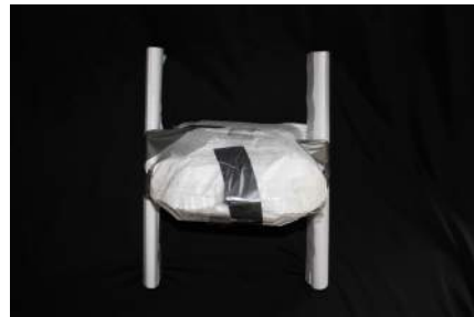
(a) De polystyreenschuimen dummy-romp dat gebruikt wordt bij de valproef.
