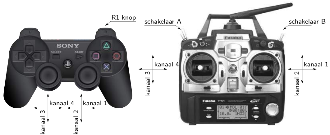
Figuur 4.1: Toekenning van kanalen en functies op een PlayStation3-controller (links) en Futaba-zender (rechts).
