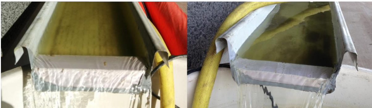
Figuur 46: Overstort van 6cm (links) en 4cm (rechts)
