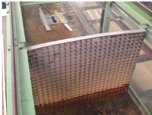
Figuur 35: Verstoring van de stroming met rooster
