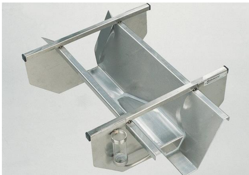
Figuur 8: RBC-meetgoot voor kleine waterlopen [20]
