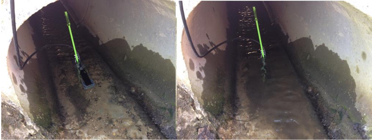
Figuur 44: Strooming zonder geforceerde omwoeling (links) en met geforceerde omwoeling (rechts)
