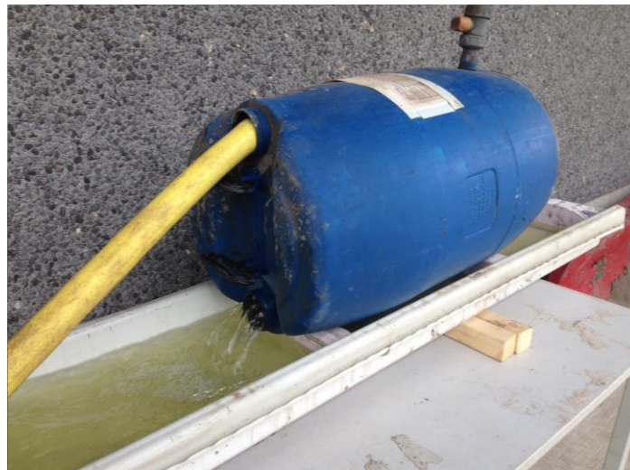
Figuur 34: Opstelling om turbulente stroming te voorkomen in de meetgoot
