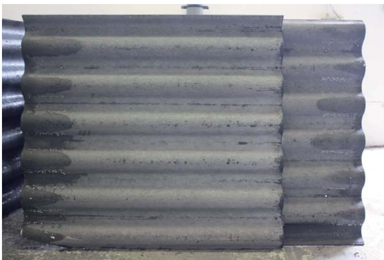
Figuur 2.25: Sporen van regen bij de overlap van de ECOLOR
