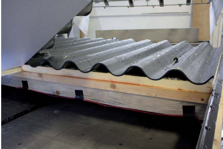
Figuur 2.28: Afwezigheid van regen in de bovenbak bij de ECOLOR ISO
