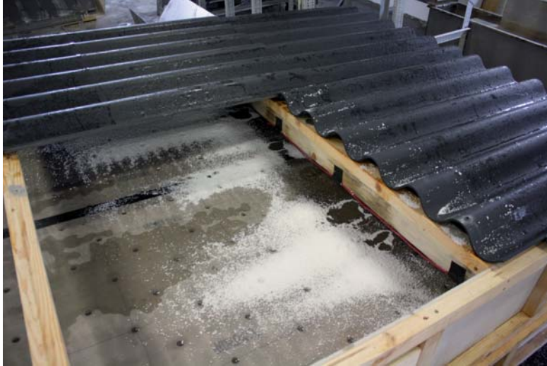
Figuur 2.24: Aanwezigheid van regen in de bovenbak bij de ECOLOR
