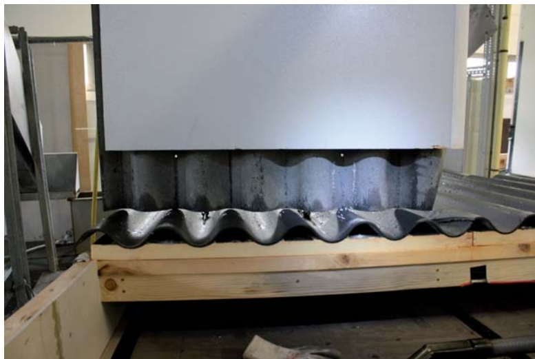
Figuur 2.27: Minimale aanwezigheid van regen bij de overlap van de ECOLOR ISO
