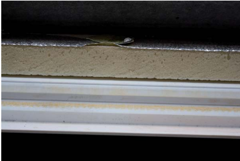
Figuur 2.40: Aftekening van de rook ter hoogte van het midden van het stoeltjesprofiel bij de ECOLOR ISO
