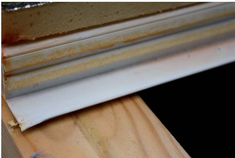
Figuur 2.41: Aftekening van de rook ter hoogte van de hoeken van het stoeltjesprofiel bij de ECOLOR ISO
