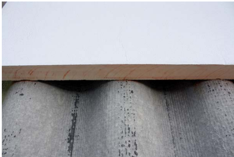
Figuur 2.42: Aftekening van de rook ter hoogte van de voeg in de breedterichting bij de ECOLOR ISO + Prestik
