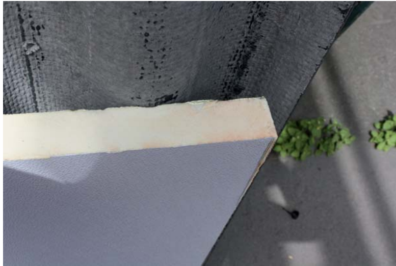
Figuur 2.44: Nauwelijks aftekening van de rook ter hoogte van de voeg in de breedterichting bij de ECOLOR ISO + dichtingskit op de gording
