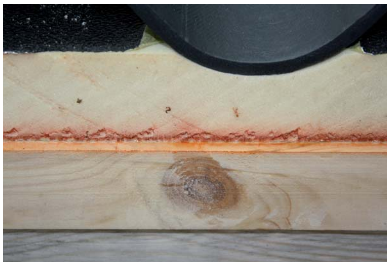
Figuur 2.39: Aftekening van de rook ter hoogte van de voeg in de breedterichting bij de ECOLOR ISO
