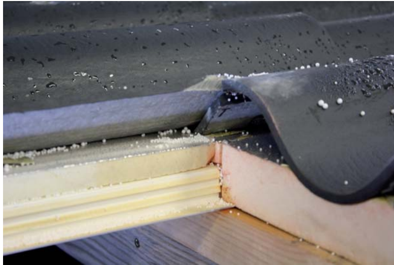
Figuur 2.34: Sneeuwophoping bij de samenkomst van de vier golfplaten blijken een cruciaal punt te zijn.
