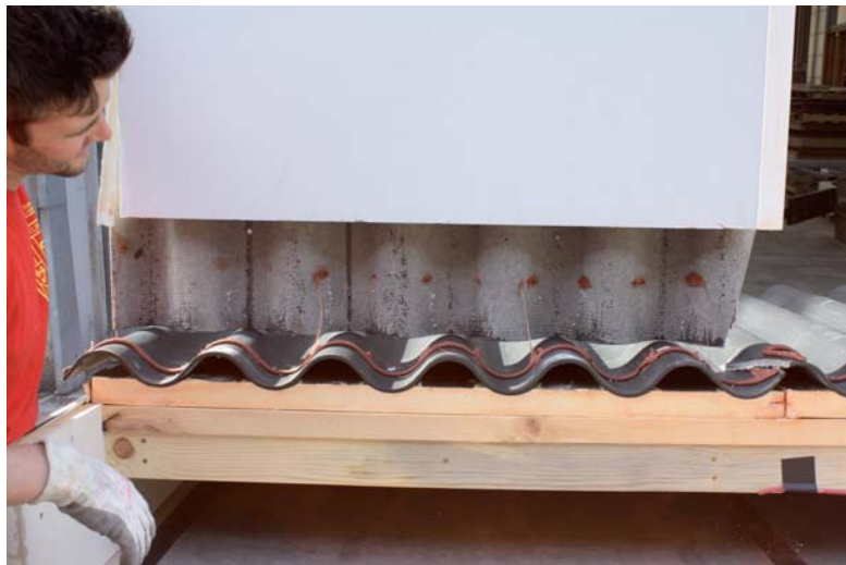
Figuur 2.35: Effectiviteit van de Prestik butylband ter hoogte van de voeg in de breedterichting van de plaat
