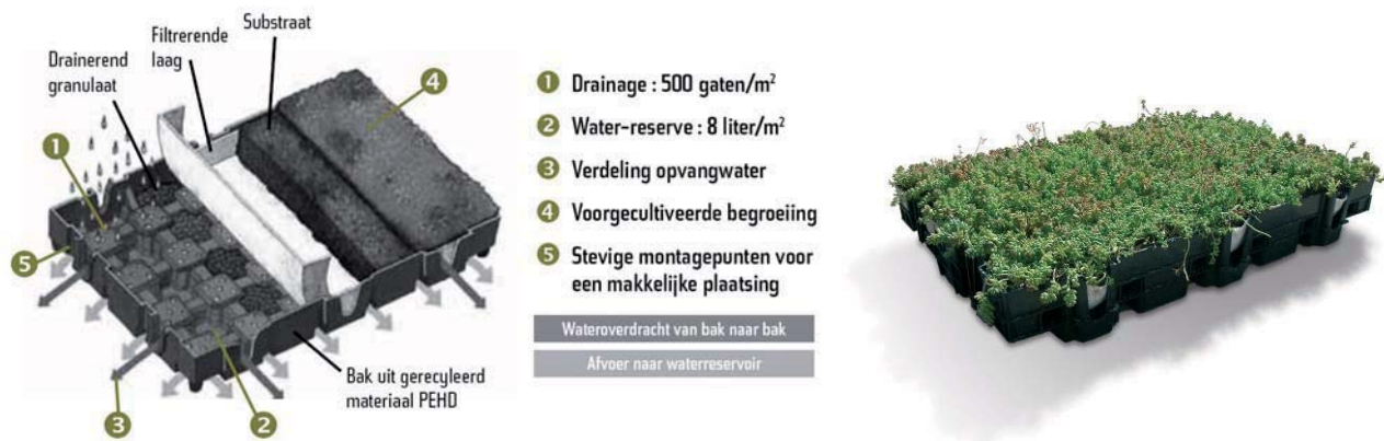
Fig. 3: Technische tekening HYDROPACK®
