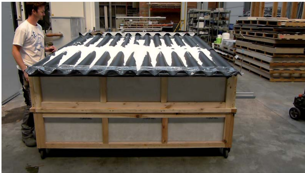
Figuur 2.29: Opstelling van de sneeuwproef
