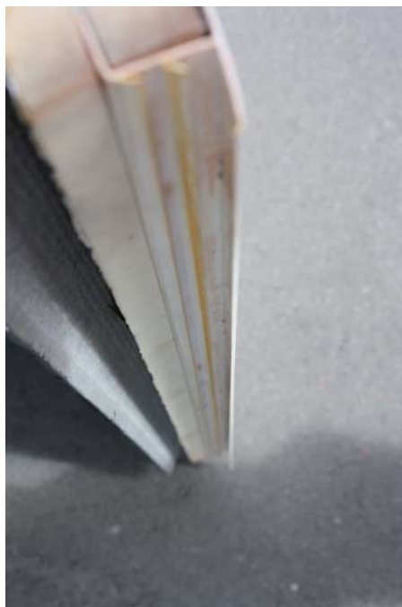
Figuur 2.45: Aftekening van de rook op het stoeltjesprofiel bij de ECOLOR ISO
