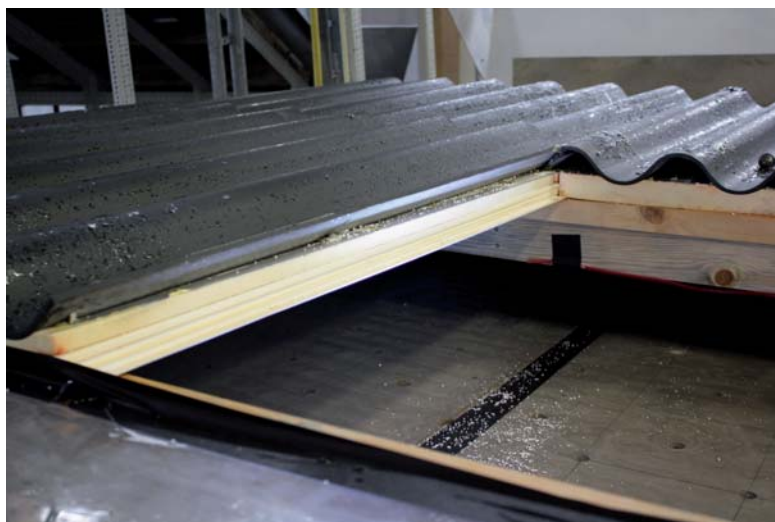
Figuur 2.32: Minimale aanwezigheid van sneeuw in de bovenbak bij de ECOLOR ISO
