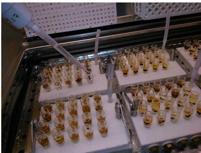
Figuur 9: Opstelling die de glasfilter in de glazen flacons weergeeft . De micropipet waarmee de oplossingen werden toegevoegd, is eveneens in beeld gebracht. De procedure werd uitgevoerd in een warmwaterbad bij 60°C (Eigen fotomateriaal).
