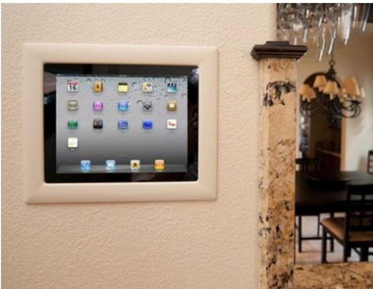
Figuur 7: Bevestigingssysteem voor tablet in muur
