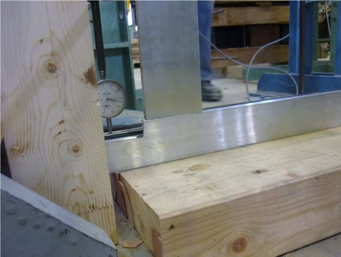
Figuur 56: Analoge meetklok om omhoogkomen van kader op te meten
