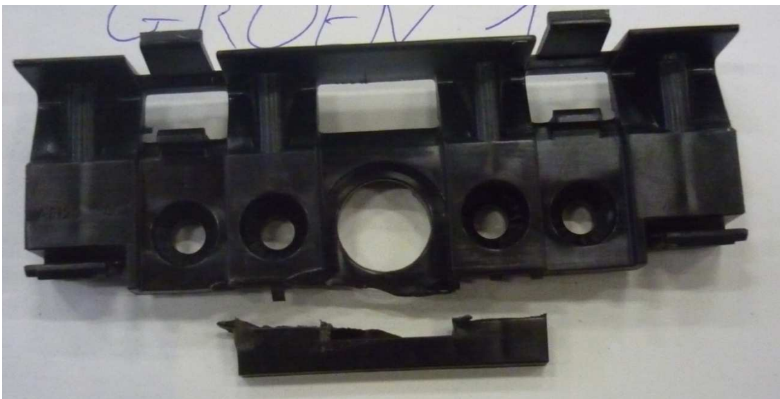
Figuur 65: Breuk in de steunblok door excentriciteit belasting
