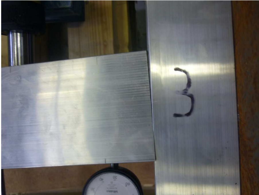
Figuur 60: Vervorming onversterkte T-verbinding tijdens test
