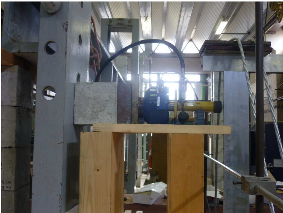
Figuur 54: Vijzel en loadcell
