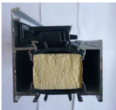
Figuur 63: Spling tussen steunblokje en profielrand
