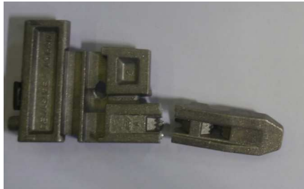
Figuur 66: Breuk verbindingstuk bij gevulde, versterkte T-kader
