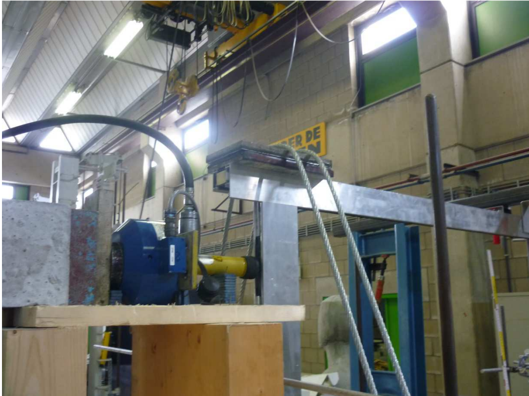
Figuur 52: Roloplegging kabels
