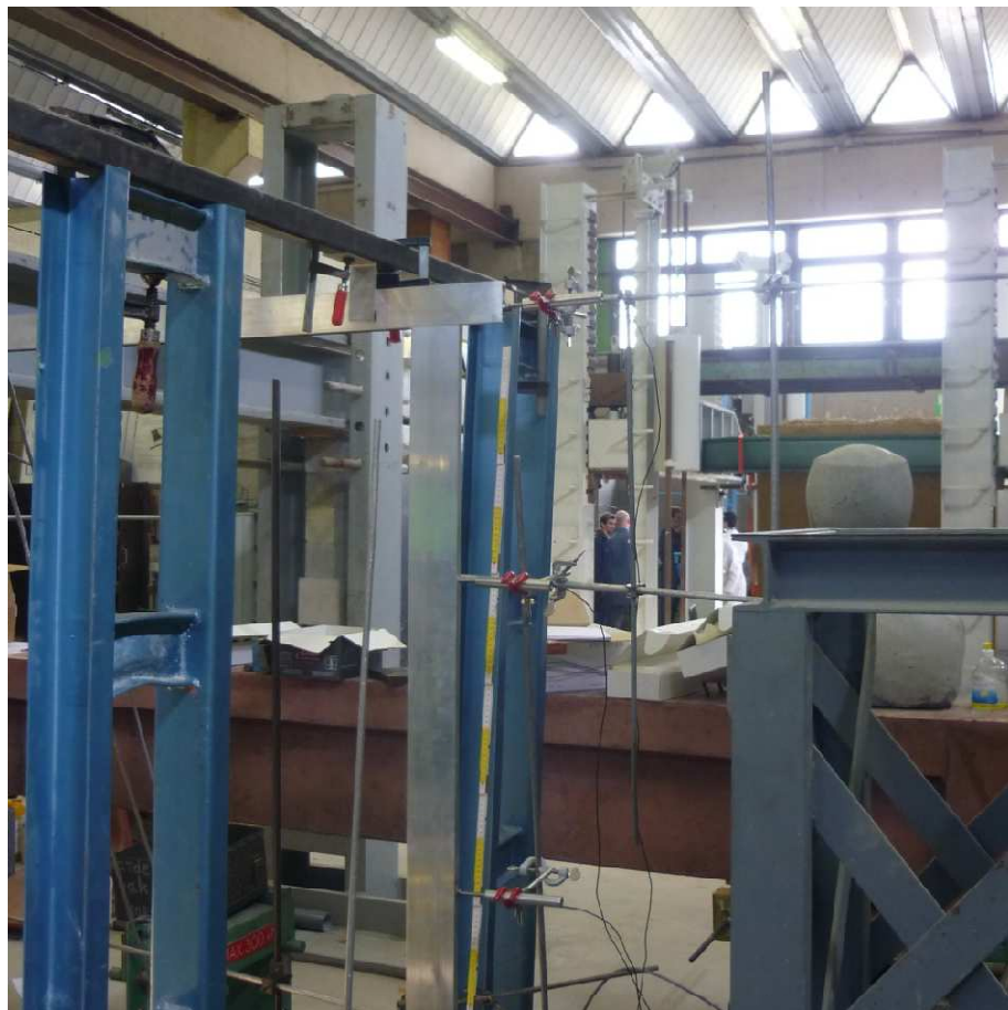
Figuur 55: Digitale meetklokken om verplaatsing in het vlak op te meten
