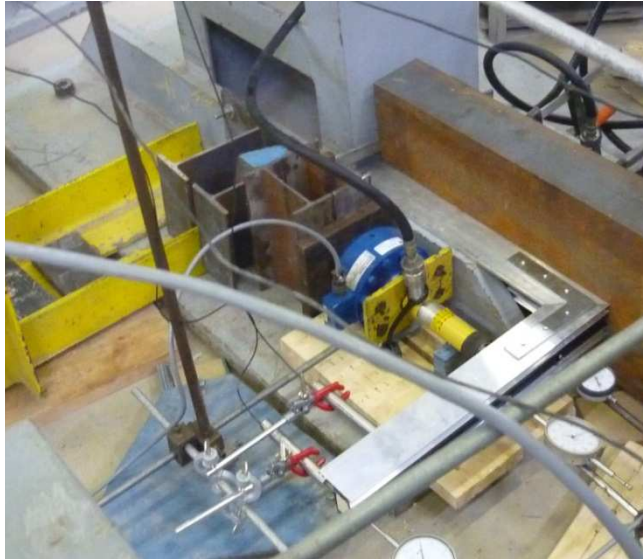
Figuur 49: Versteving van de vulstukken
