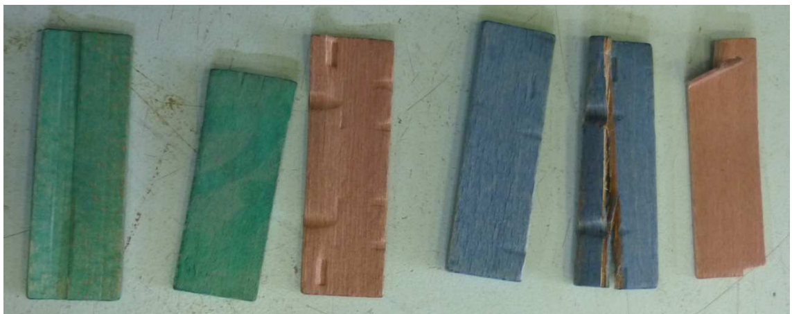
Figuur 67: Houten blokjes na breuk gevulde, versterkte T-kader
