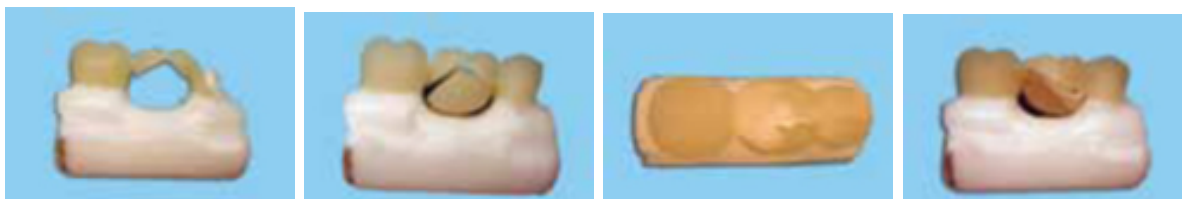
Figuur 4.12: Breukwijze van CAD/CAM brug van PFC en FRC; A: catastrofaal; B: totaal; C: gedeeltelijke breuk; D: delaminatie [2].
