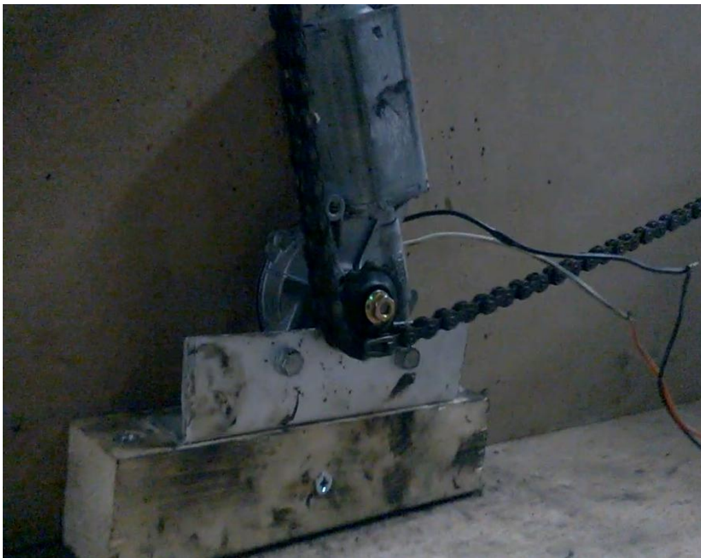
Figuur 7-3: ruitwissemotor - transportbanden
