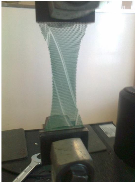
Figuur 6-3 Scheuren gevormd door trekproef in fijnste gaas
