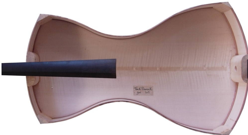
Afbeelding 14: De vorm en binnenkant van de experimentele cello voor het lijmen van het klankblad.
