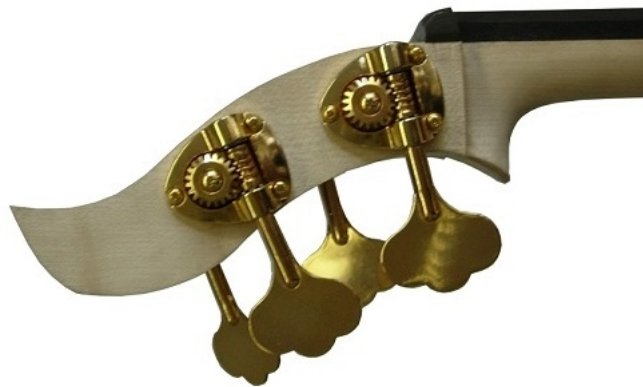
Afbeelding 15: De kop van de experimentele cello met stemmechanieken uit messing.
