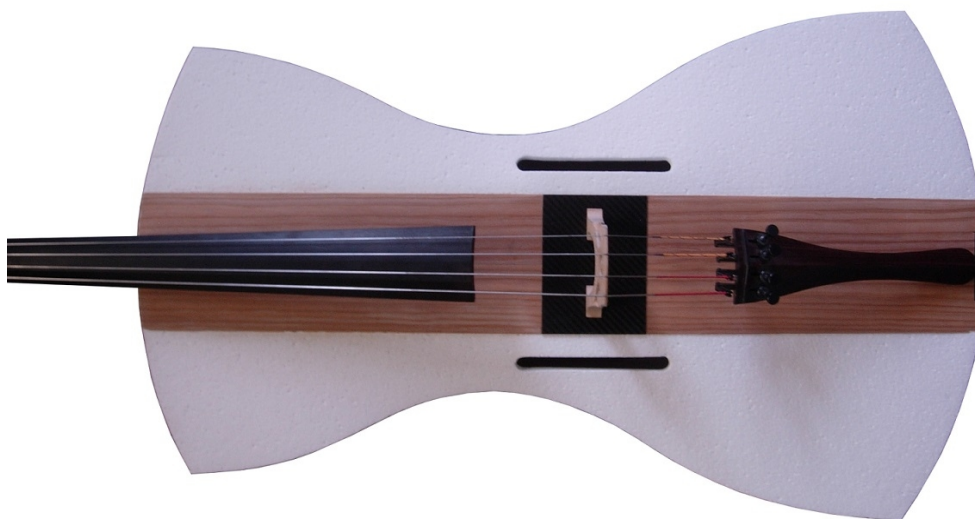
Afbeelding 13: Prototype versterkt met fineerstrook en carbonplaat
