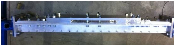
Figuur 6.8: Inklemming van linermateriaal met aluminium plaatwerk
