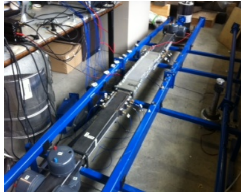
(b) Leidingsysteem voor multimodale golfvoortplanting
