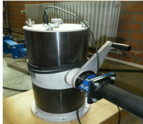
(b) Custom made luidspreker voor vlakke golfvoortplanting
