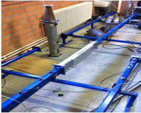
(a) Leidingsysteem voor vlakke golfvoortplanting
