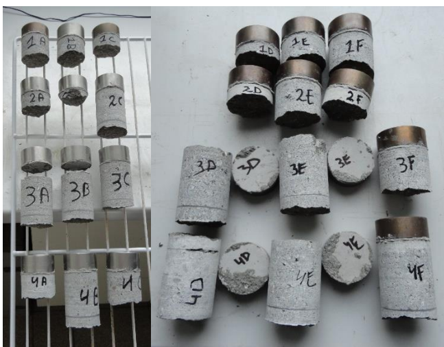
Figuur 5-39: Overzicht kernen na uitvoeren hechtsterkteproeven
