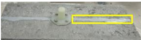
Figuur 5-34: Tegel met buitenafdichting en plakpakker
