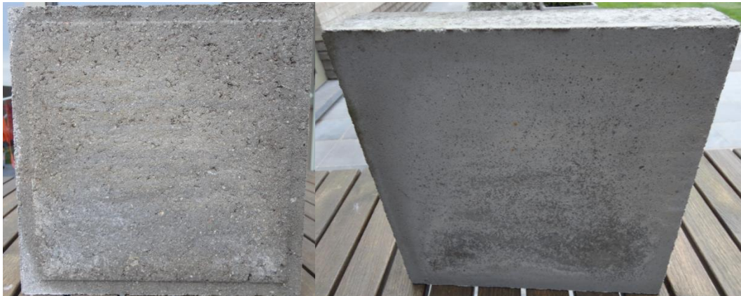
Figuur 5-45: Ruwe en gladde zijde betontegels
