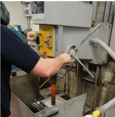
Figuur 5-36: Boren van kernen
