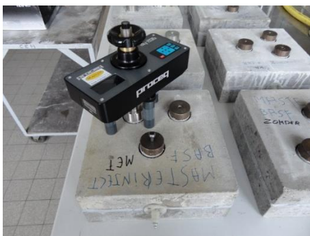
Figuur 5-38: Toestel hechtsterkte
