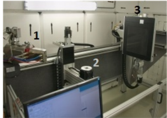
Figuur 1.1: Links een schematische voorstelling van een CT-opstelling, rechts een foto van HECTOR [3], de ‘hoge energie CT-scanner, geoptimaliseerd voor onderzoek’ van UGCT. Te zien zijn de X-stralenbuis (1), de rotatiemotor waarop het te bestuderen voorwerp wordt geplaatst (2) en de detector(3).
