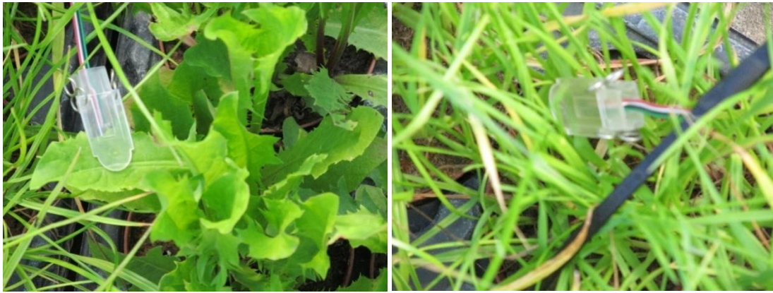
Figuur 10: Bladklem bevestigd op T. officinale (links) en L. perenne (rechts).
