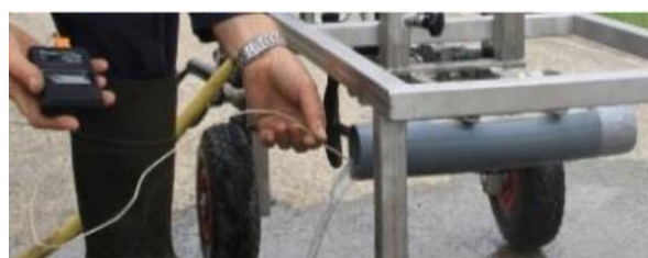
Figuur 6: Temperatuursbepaling via opvangcilinder ter hoogte van de uitstroomlijn.
