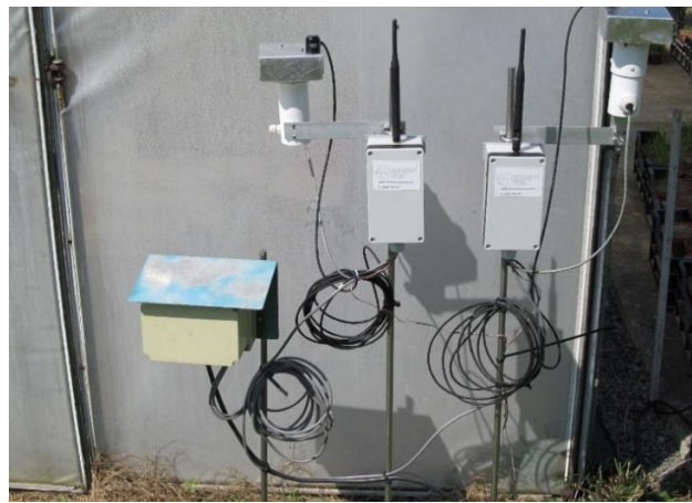
Figuur 11: De opstelling gebruikt voor de meteorologische waarnemingen en het meten van de bladdikte met sensortechnologie (geplaatst door het Laboratorium voor Plantecologie, Faculteit Bio-ingenieurswetenschappen, UGent).
