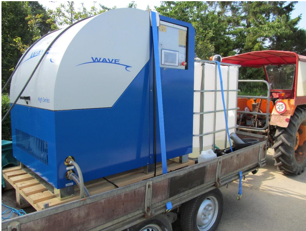
Figuur 5: Het verwarmingsgedeelte; High Series 75/30, Wave weed control.
