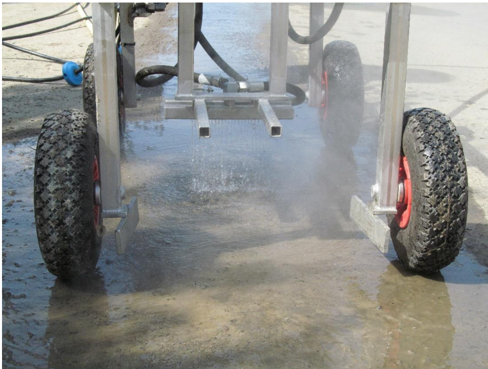
Figuur 8: De uitstroomlijn met heet water stromend door de uitstroomgaten.
