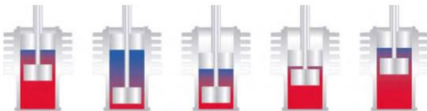
Figuur 36: Werking vrijbewegende zuiger stirlingmotor
