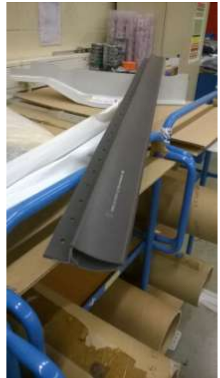
Figuur 34: Eén van de drie seals van de MOV3 fairing
