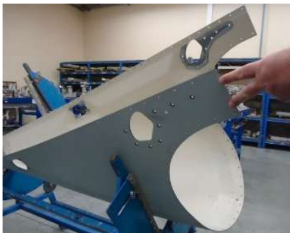
Figuur 52: FIX fairing aanduiding de te boren gaten
