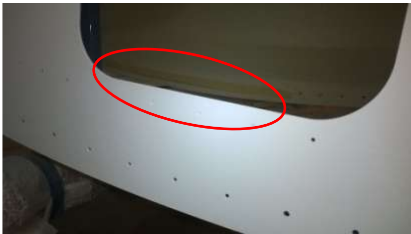
Figuur 57: Onvoltooide boringen MOV fairing
