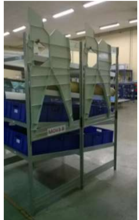
Figuur 36: Reinforcement panels aan het Kanban rek
