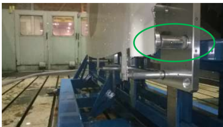
Figuur 56: Fairing (MOV) op de mal in de trimmachine
