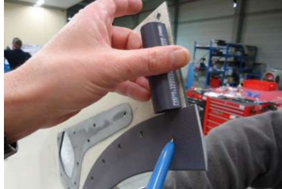
Figuur 55: Rechterkant FIX fairing waar boring tekort
