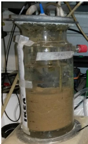
Figuur 19: Uitzicht van de SBR in de bezinkingsfase op dag 1 van het experiment (reactortemperatuur = 38 °C).
