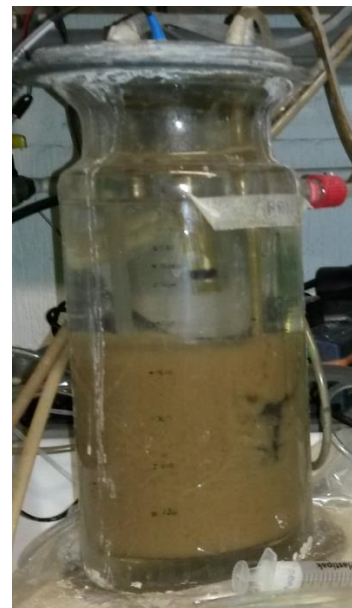
Figuur 21: Uitzicht van de SBR in de bezinkingsfase op dag 107 van het experiment (reactortemperatuur = 46 °C).
