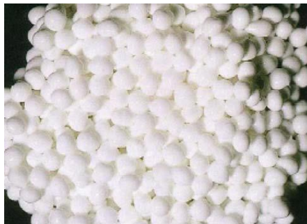
Figuur 2: PVA-gel carriers voor gebruik (Levstek et al., 2010).
