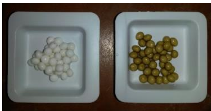
Figuur 22: Ongebruikte carriers (links) en geïnoculeerde carriers op dag 164 van het experiment (rechts).
