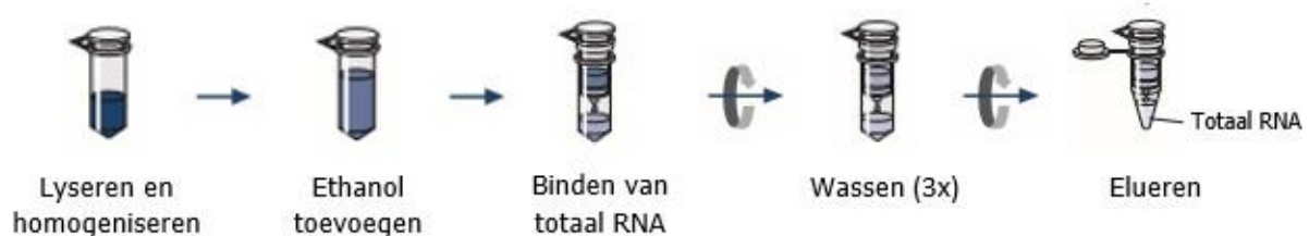
Figuur 8 RNA-extractiestappen volgens de RNeasy Mini kit
