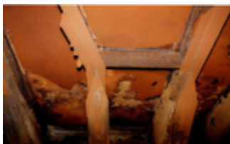
FIGUUR 2: EEN GEORRODEERDE LADINGTANK. (RAUTA ET AL., 2004)
