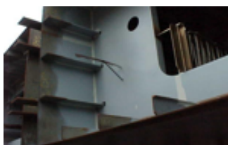
FIGUUR 5: DE TOEKOMSTIGE LASNADEN TUSSEN DE VERSCHILLENDE SCHEEPS-BLOKKENDE: DE ACHILLESHIEL VAN PSPC-COT. (WEI ET AL., 2011)
