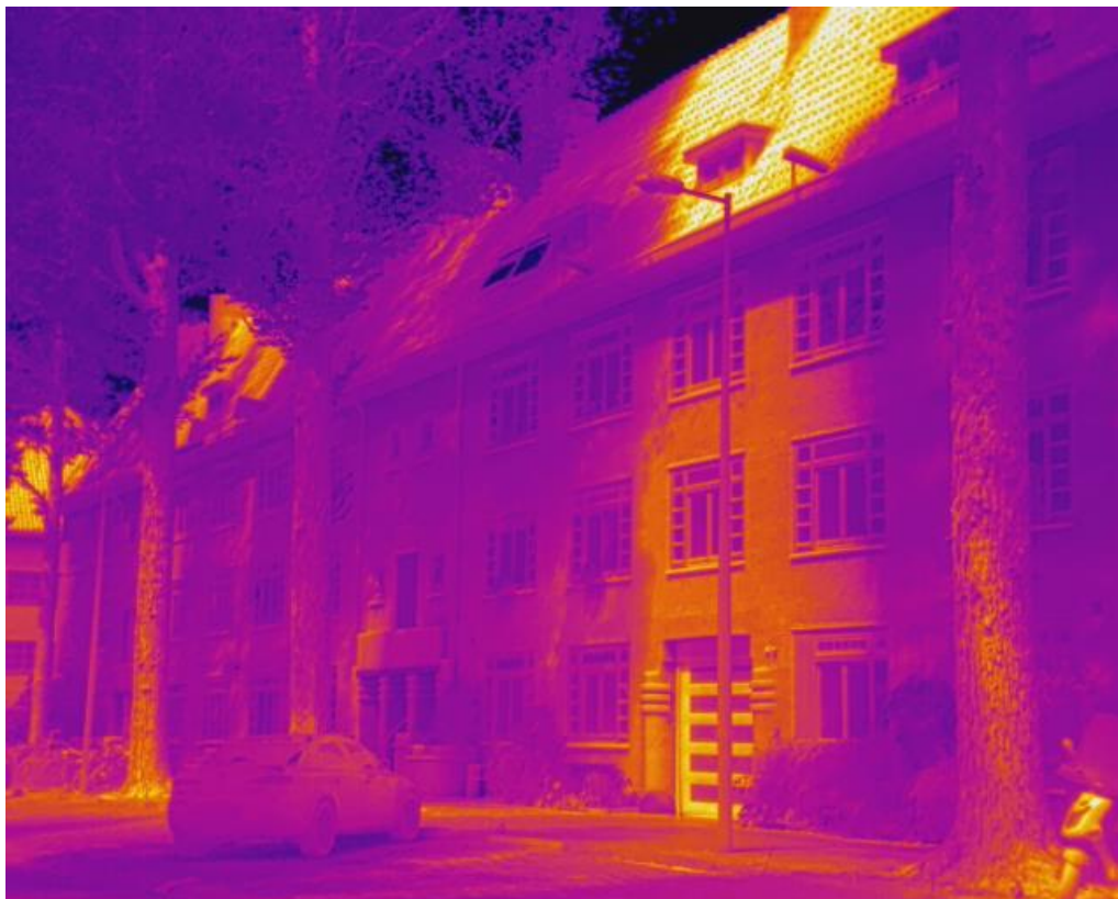
Warmtebeeld van huizen in Amsterdam. De temperaturen van het dak in de zon en in de schaduw zijn respectievelijk ongeveer 60 en 37 °C.
