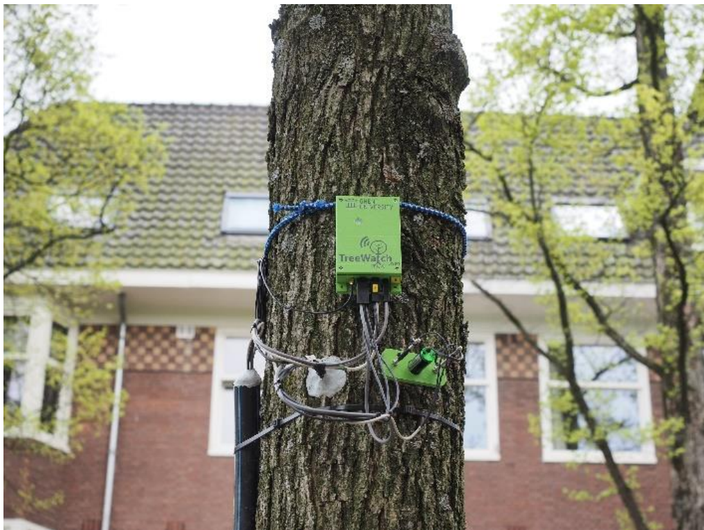
Treewatch.net technologie met sapstroomsensoren om het waterverbruik van bomen te meten.
